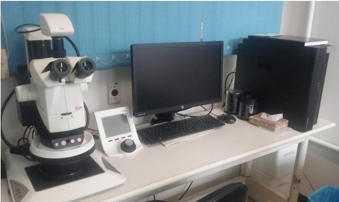
Figura 1: Estereomicroscópio acoplado a câmera com sistema de captura de imagens e desenhos (Leica M205C).
