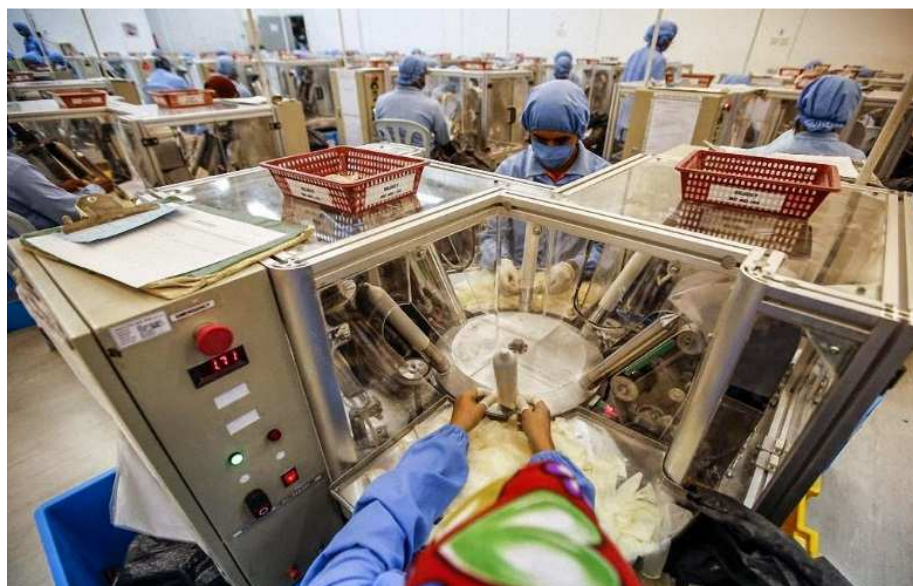
Figura 6 – Teste elétrico feito na fábrica para detecção de orifícios
