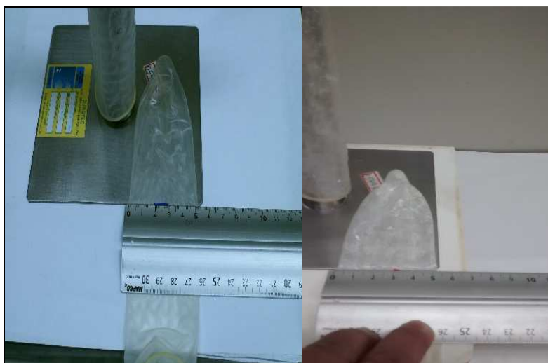
FIGURA 13 – Régua utilizada para medir a largura dos preservativos
