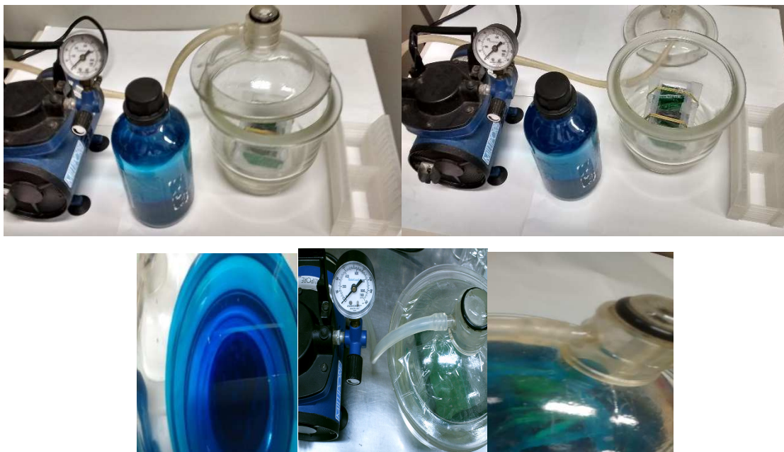
Figura 16 – Aparelho usado para realizar o teste de verificação da integridade de embalagens primária dos preservativos
