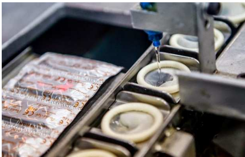
Figura 8 - Colocação de lubrificante antes da vedação da embalagem primária.
