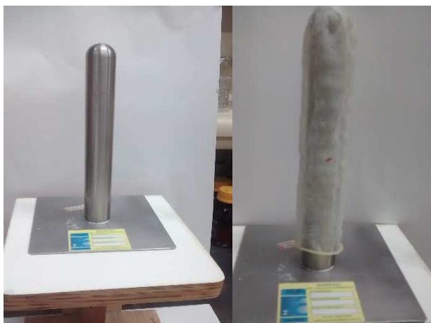
FIGURA 12 – Mandril usado para medida de comprimento de preservativos
