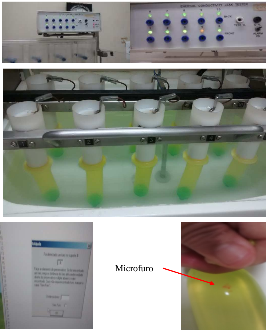
Figura 15 – Equipamento usado no teste de verificação de orifícios de preservativos masculinos
