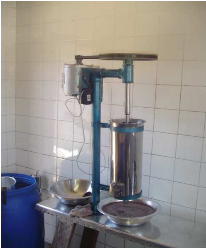
Figura 2 - Despoldadora (batedeira) vertical de açai
