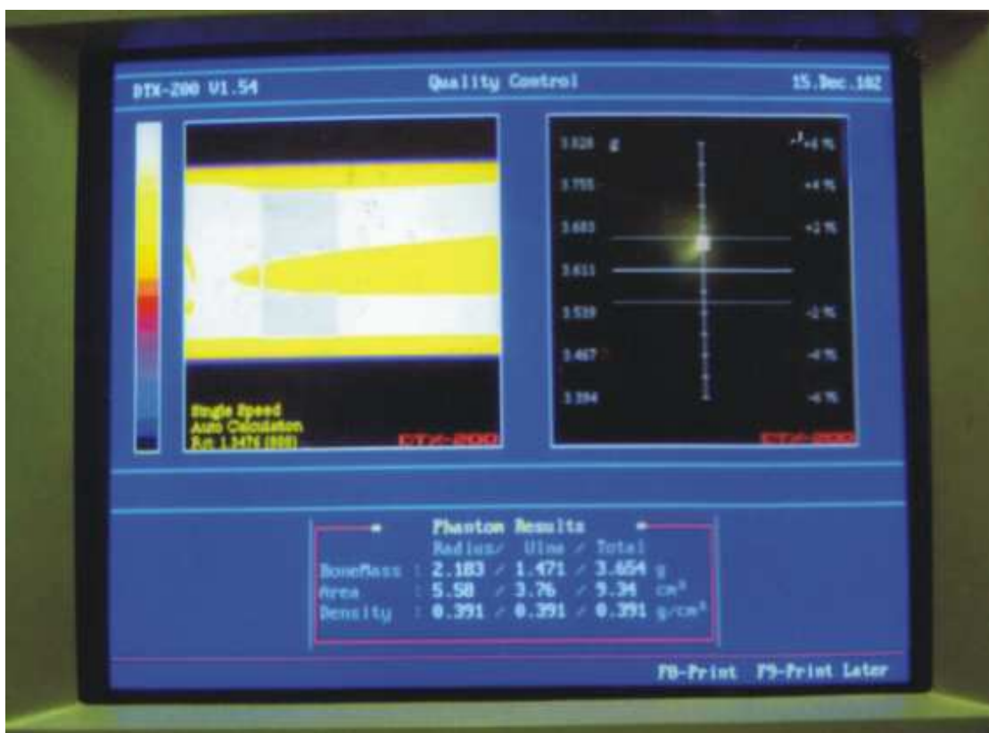
Figura 3.1 – Calibração diária por phantom do DXA de antebraço, modelo DTX-200, pertencente ao HGeF. Fonte: Fontenele et al. (2003a).
