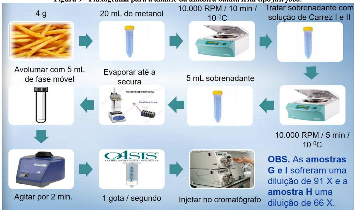
Em todas as análises realizadas os padrões e as amostras foram solubilizados em fase móvel: água/acetonitrila (95:5, v/v) para que houvesse uma diminuição do ruído provocado pela linha de base no cromatograma.
