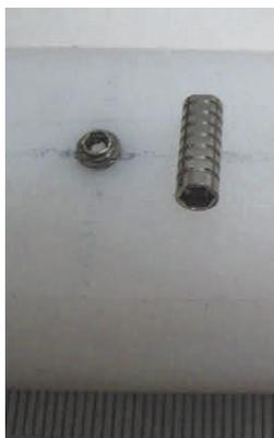
Figura 11: CP\_127.16ED-08 - Ruptura do parafuso de ligação pilar/implante a 9,31 mm do ponto C.
