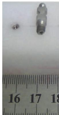
Figura 9: CP\_126.16ED-06 - Ruptura do implante a 11,89 mm do ponto C.
