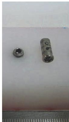
Figura 9: CP\_128.16ED-06 - Ruptura do parafuso de ligação pilar/implante a 9,29 mm do ponto C.
