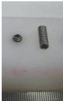
Figura 7: CP\_127.16ED-04 - Ruptura do parafuso de ligação pilar/implante a 10,32 mm do ponto C.
