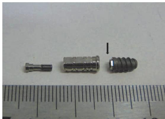
Figura 1: Corpo de prova antes do ensaio. A seta indica o nível ósseo informado pelo fabricante (2 mm infra-ósseo).
