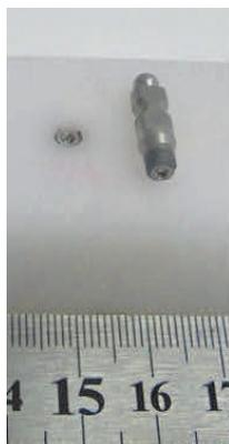
Figura 7: CP\_126.16ED-04 - Ruptura do implante a 11,68 mm do ponto C.
