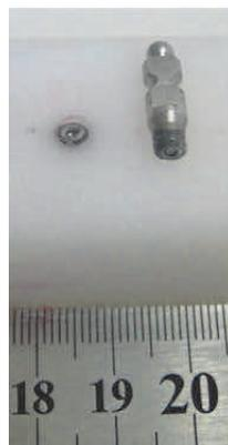
Figura 11: CP\_126.16ED-08 - Ruptura do implante a 11,81 mm do ponto C.
