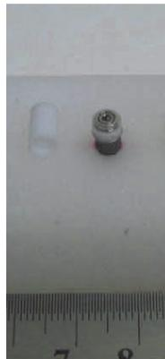
Figura 4: CP\_129.16ED-01 - Ruptura do pilar a 4,04 mm do ponto C.
