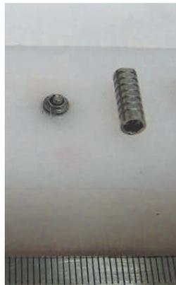
Figura 6: CP\_127.16ED-03 - Ruptura do parafuso de ligação pilar/implante a 9,27 mm do ponto C.
