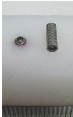
Figura 4: CP\_127.16ED-01 - Ruptura do parafuso de ligação pilar/implante a 09,28 mm do ponto C.
