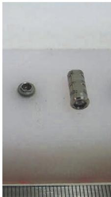
Figura 10: CP\_128.16ED-07 - Ruptura do parafuso de ligação pilar/implante a 9,32 mm do ponto C.
