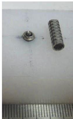
Figura 9: CP\_127.16ED-06 - Ruptura do parafuso de ligação pilar/implante a 9,28 mm do ponto C.
