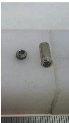
Figura 12: CP\_128.16ED-09 - Ruptura do parafuso de ligação pilar/implante a 9,32 mm do ponto C.
