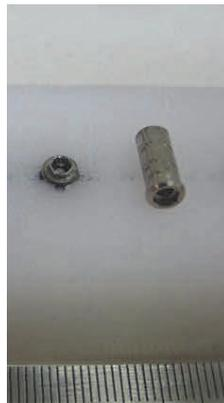
Figura 4: CP\_128.16ED-01 - Ruptura do parafuso de ligação pilar/implante a 9,28 mm do ponto C.
