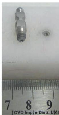
Figura 12: CP\_126.16ED-09 - Ruptura do implante a 12,13 mm do ponto C.
