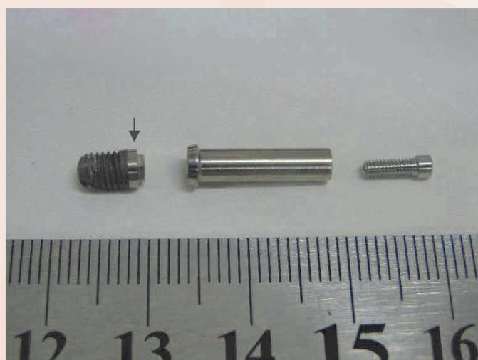
Figura 1: Foto do corpo de prova antes do ensaio. A seta mostra o nível ósseo indicado pelo fabricante.
