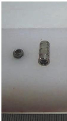
Figura 11: CP\_128.16ED-08 - Ruptura do parafuso de ligação pilar/implante a 9,33 mm do ponto C.
