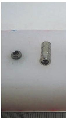
Figura 5: CP\_128.16ED-02 - Ruptura do parafuso de ligação pilar/implante a 9,29 mm do ponto C.
