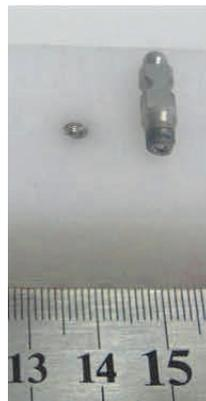
Figura 10: CP\_126.16ED-07 - Ruptura do implante a 11,72 mm do ponto C.
