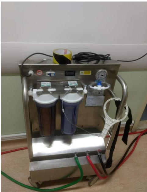
Figura 12 – Aparelho de osmose portátil posicionado exteriormente ao leito de isolamento de bactérias multidrogas resistentes (MDR)
