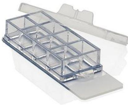
**Figura 3.1: Representação de uma lâmina Nunc™ Lab-Tek™** utilizada nos experimentos de padronização da infecção pelo DENV2. A depender do ensaio realizado, cada poço tinha uma concentração de células e vírus a serem testadas. Os dois últimos poços sempre eram controles negativos da infecção. Foto: Thermo Fisher.
