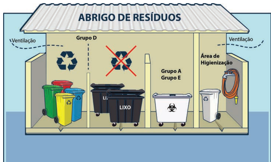
Figura 1 – Exemplos de estrutura adequada para a guarda dos resíduos acondicionados até a coleta externa
