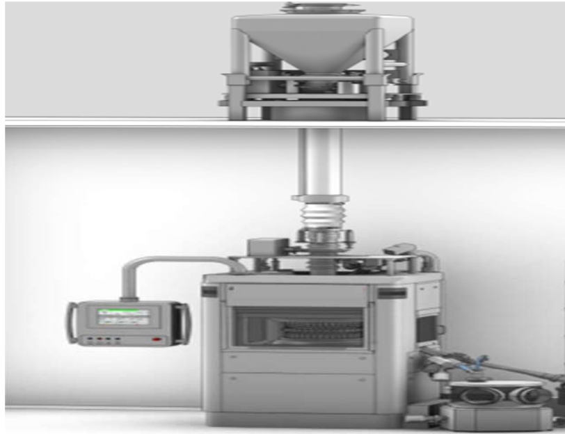
Figura 44: Alimentação por gravidade para compressoras rotativas de alta velocidade. Fonte: Adaptado de Temoche (2019).
