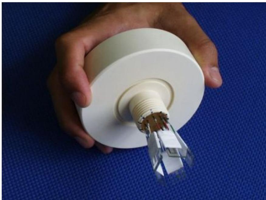
Figura 8 - Detalhe dos sensores da Língua eletrônica desenvolvida pela Embrapa Instrumentação Agropecuária de São Carlos (EMBRAPA, 2013).
