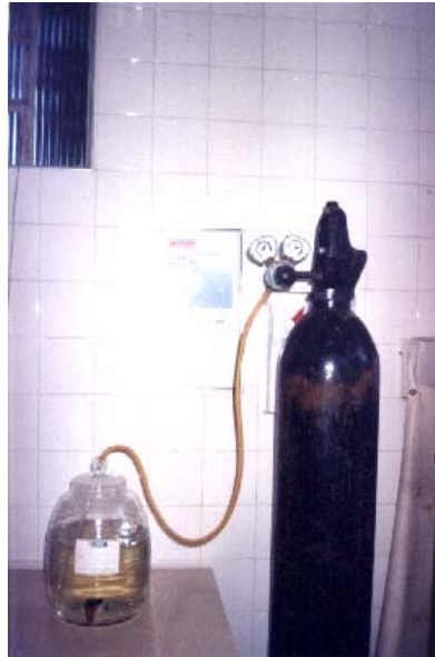
Figura 19: Sistema de Injeção de Oxigênio de alta pureza
