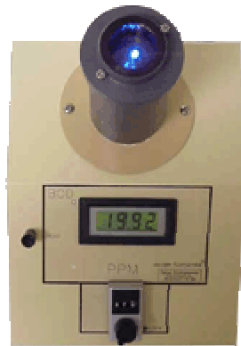
Figura 15 - Aparelho para ensaio por Luminescência
