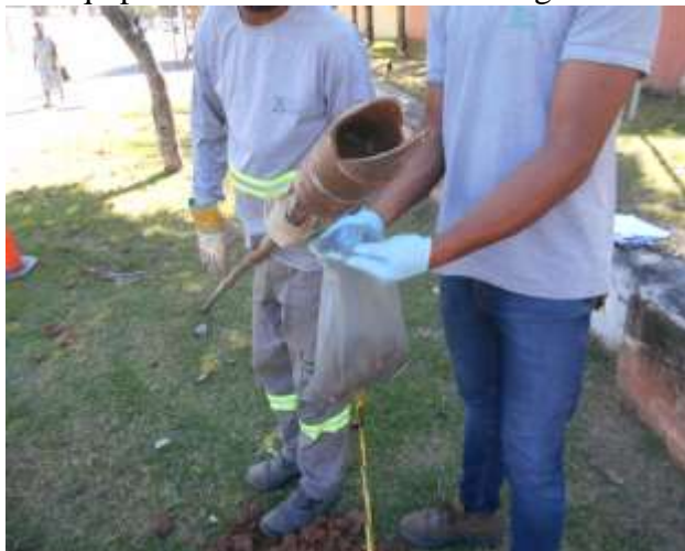
Figura 12: Equipamentos utilizados na sondagem de solo, trado tipo concha e cavadeira.
