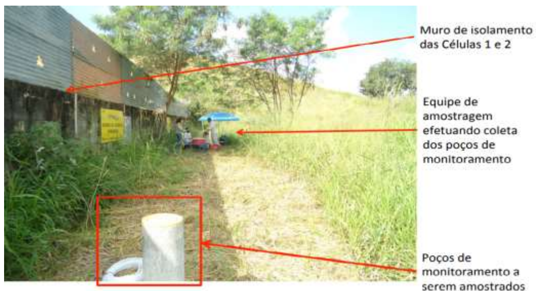
Figura 6: Poços de monitoramento das células do depósito.
