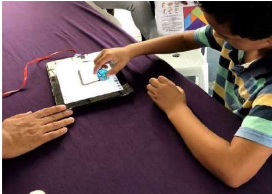
Figura 2 - Participante colocando o Ozobot sobre a linha desenhada no tablet e compreendendo o funcionamento dele sem que tenham sido aplicados comandos de programação.
