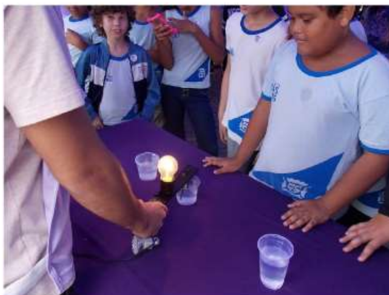
Figura 2 – mediador demonstrado a condutividade da solução aquosa. Ressalta-se que esta atividade contém risco de choque por isso a interação do público com ela é restrita.
