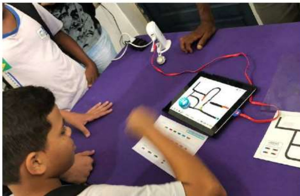
Figura 3 - Participante observando a movimentação do Ozobot e inserindo os comandos de programação no circuito desenhado no tablet. Os comandos são os traços coloridos na tela do tablet, a partir deles o robô define parâmetros como velocidade, mudar de direção, seguir numa direção sem linha, entre outros.
