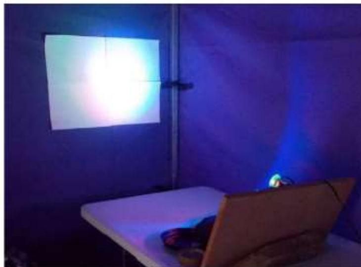
Figura 1 - Projeção de um foco de luz em uma superfície branca (tela), utilizando-se um dispositivo com três lâmpadas LED, uma verde, outra vermelha e outra azul. Ao fundo projetando um foco de luz branca.
