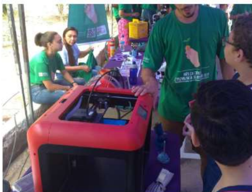
Figura 1 – Impressora 3D FlashForge em funcionamento utilizando filamento PLA vermelho. Pode-se observar tanto o equipamento quando o filamento nessa imagem, além disso é possível observar, sobre a mesa, diversos objetos produzidos com finalidades distintas desde decorativos até modelos de prótese.
