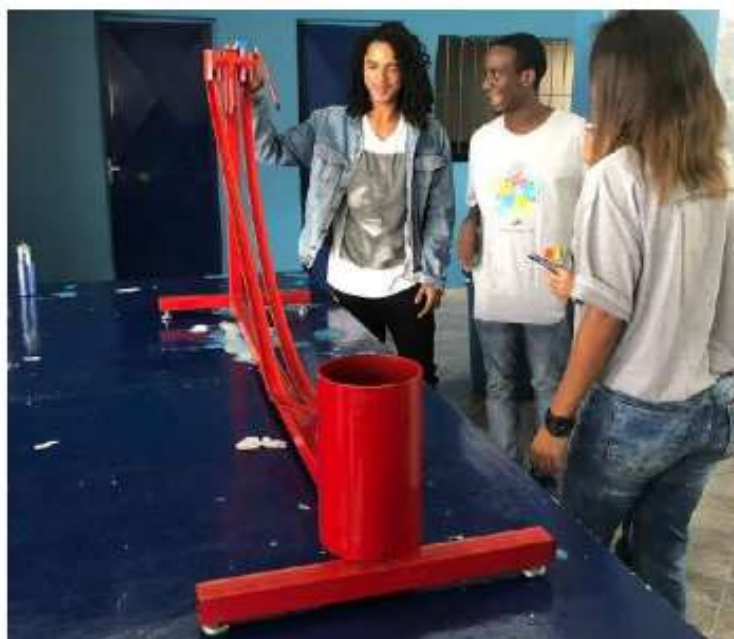
Figura 1 – Rampa com as duas curvas de trajetória. O público é convidado a testar e experimentar as variáveis do experimento como tempo de deslocamento, a massa das bolas arremessadas entre outras possibilidades.
