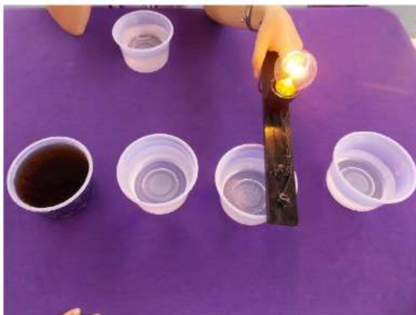
Figura 1 - Diferentes soluções utilizadas para realização da atividade, demonstrando a eletrocondutividade delas. A primeira solução trata-se de um refrigerante de cola, as outras são a base de água com variações de concentração de sais.
