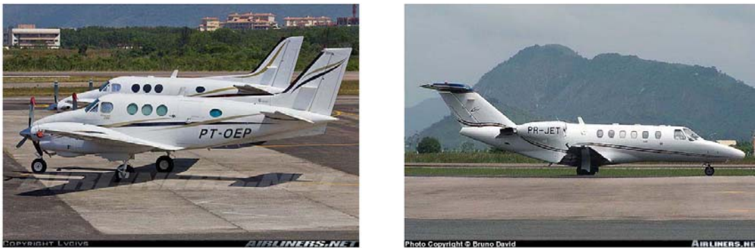
Figura 5.5: Modelos de aviões mais utilizados no SBJR, aeronave turboélice BEECH AIRCRAFT C90A (à esquerda) e aeronave a jato CESSNA 525 (à direita). (Fonte: < http://cdn-www.airliners.net >, 26/07/2012).
