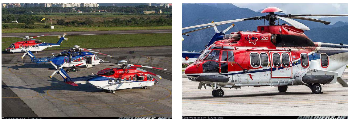
Figura 5.7: Helicópteros de grande porte com 19 assentos que operam no transporte offshore no SBJR, modelo S-92 (à esquerda) e EC225 (à direita) da BHS Taxi Aéreo.
