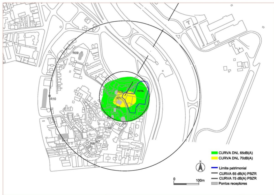
Figura 5.29: Curvas de ruído DNL para análise segundo o PBZR (2 operações diurnas do BELL407, 2 operações diurnas e 2 operações noturnas do AS50 Esquilo).
