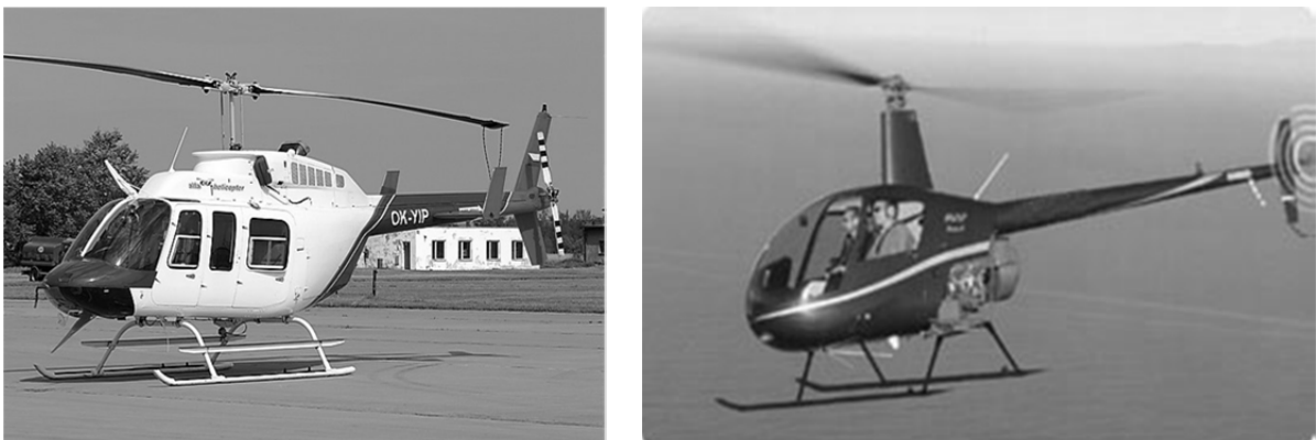
Figura 1.1: Exemplos de helicópteros equipados com motor a turbina (à esquerda) e motor à pistão (à direita).
