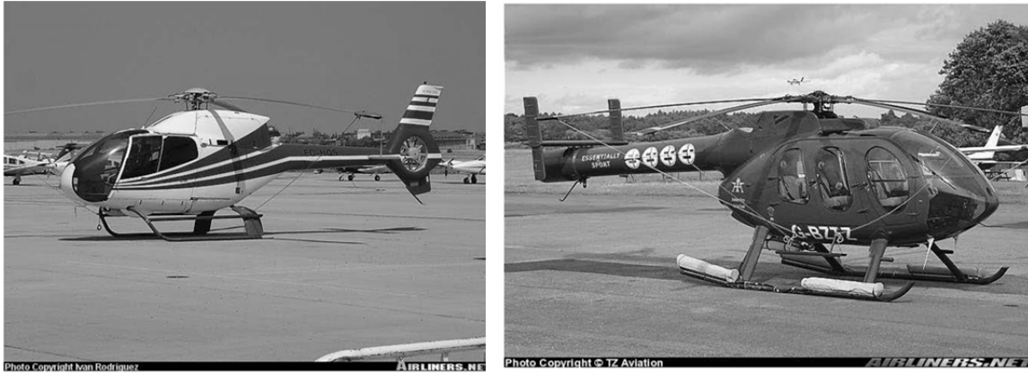
Figura 1.4: Helicóptero modelo EC120 Colibri equipado com Fenestron à esquerda, e o modelo MD600N com a tecnologia NOTAR, à direita.
