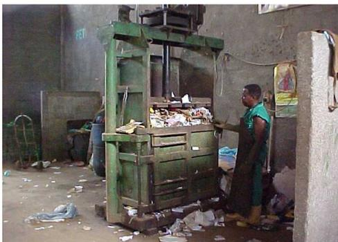
Foto 5: Prensa Hidráulica
