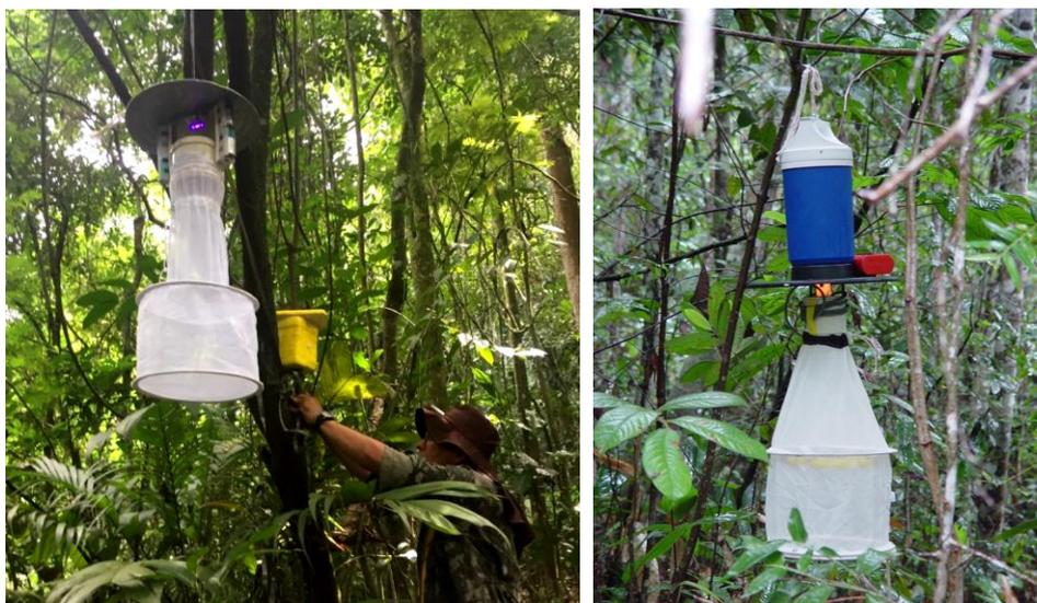
**Figura 9** - Instalação das armadilhas luminosas do tipo CDC com CO<sub>2</sub> na área de amostragem do Parque Nacional da Serra dos Órgãos.
