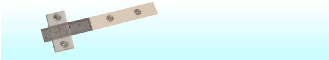
Figura 57 - Medidor uniaxial de trinca.
