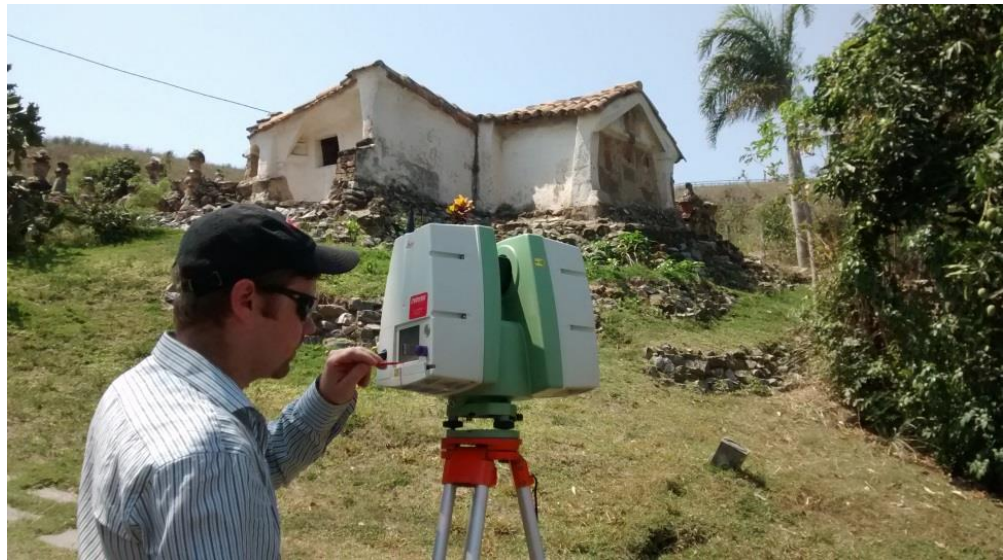
Figura 41 – Equipamento sendo calibrado e nivelado para a primeira cena pelo técnico Kesyo Arruda. Fonte: Acervo Ivo Barreto, 2016.
