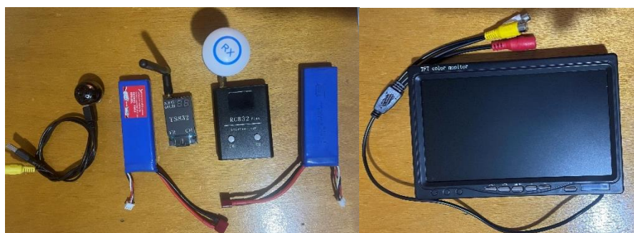
Figura 136 - Sistema de transmissão sem fio para vídeos em tempo real.
