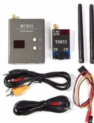
Figura 126 - Equipamento para transmissão sem fio das imagens captadas pelas câmeras de pilotagem do veículo de controle remoto. FONTE: Autor.
