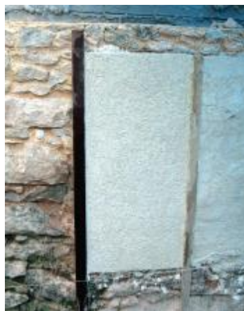
Figura 17 – Argamassa-teste grupo A1 – acabamento desempenhado para o emboço.
