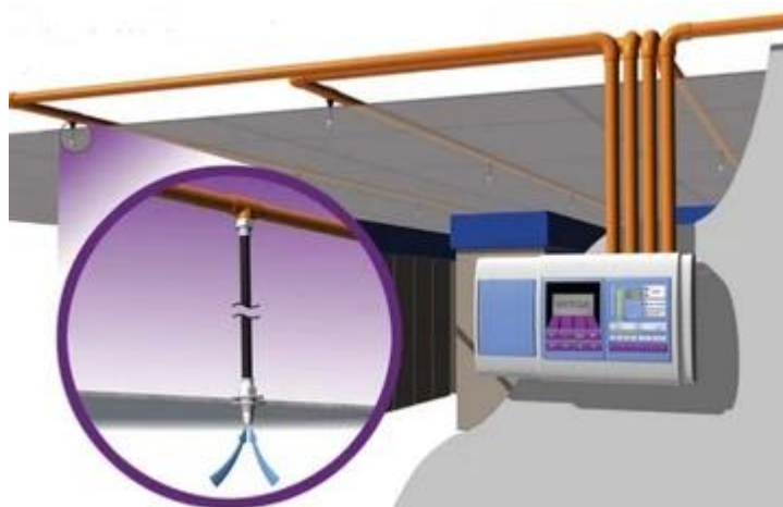
Figura 68 - DETECÇÃO POR ASPIRAÇÃO - VESDA.
