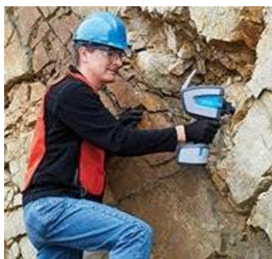
Figura 106 - Exemplo de trabalho de campo com o Espectrômetro FTIR portátil.
