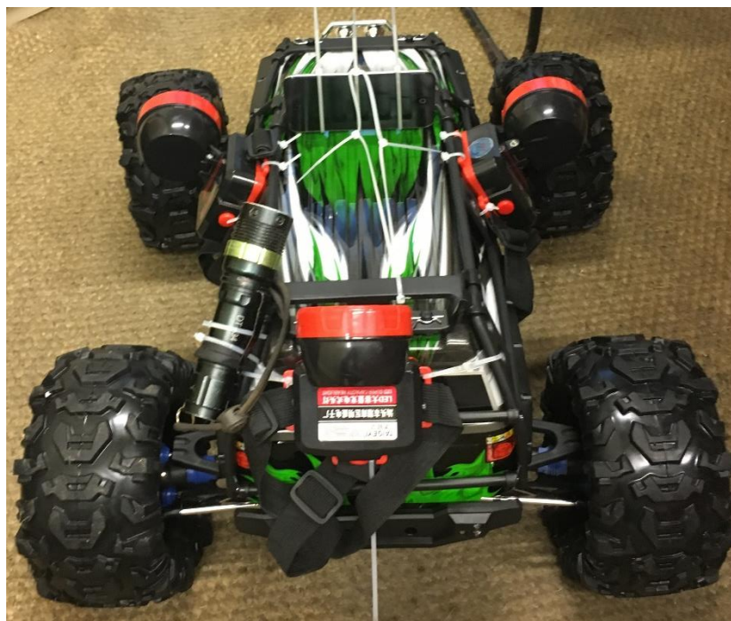
Figura 113 - Primeiro protótipo do veículo de controle remoto com câmera feito em 2016.
