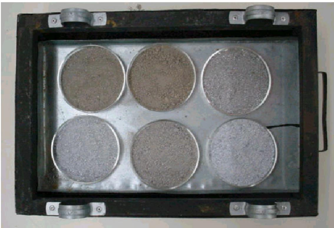
Figura 3.4 – Amostras de solo na bandeja do reator
