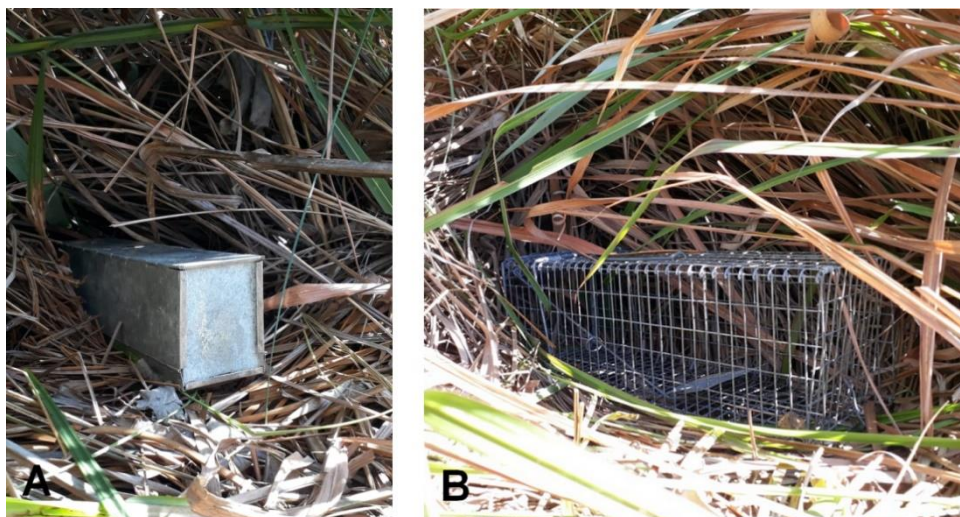
Figura 9: Armadilhas tipo “live trap” utilizadas para captura dos hospedeiros roedores. (A) Sherman® (B) Tomahawk®. Fonte: Acervo próprio
