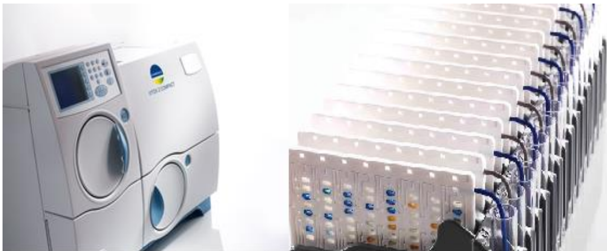
Figura 13 – Vista frontal do equipamento VITEK 2® (BioMérieux) e seus cartões inseridos em cassetes.
