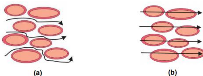
Figura 4: (a) Fluxo de corrente elétrica de baixa frequência em um tecido. (b) Fluxo de corrente elétrica de alta frequência em um tecido.
