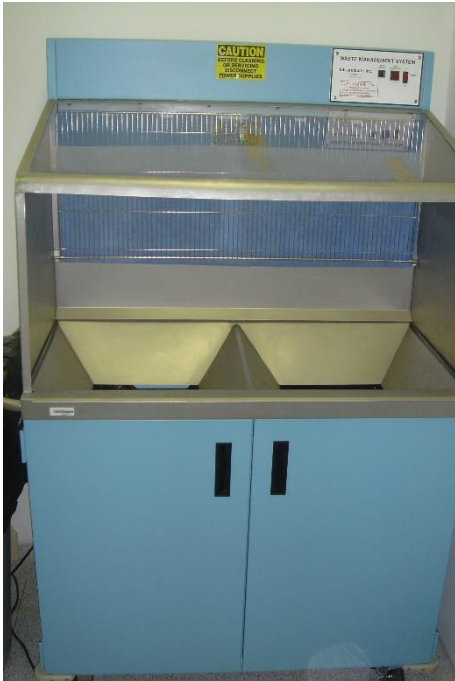
Figura 16. Cabine para descarte de forração de gaiolas.
