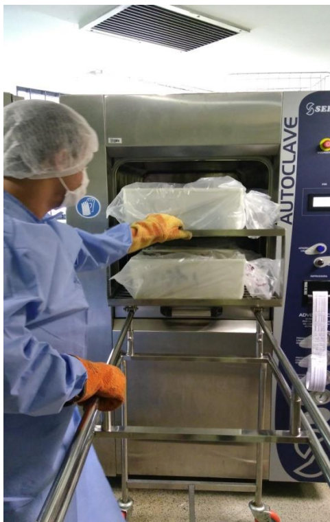
Figura 50. Retirada de bebedouros autoclavados.
