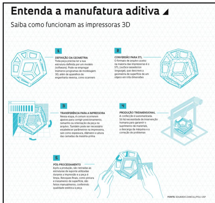
Figura 1: Esquema da manufatura em impressão 3D.
