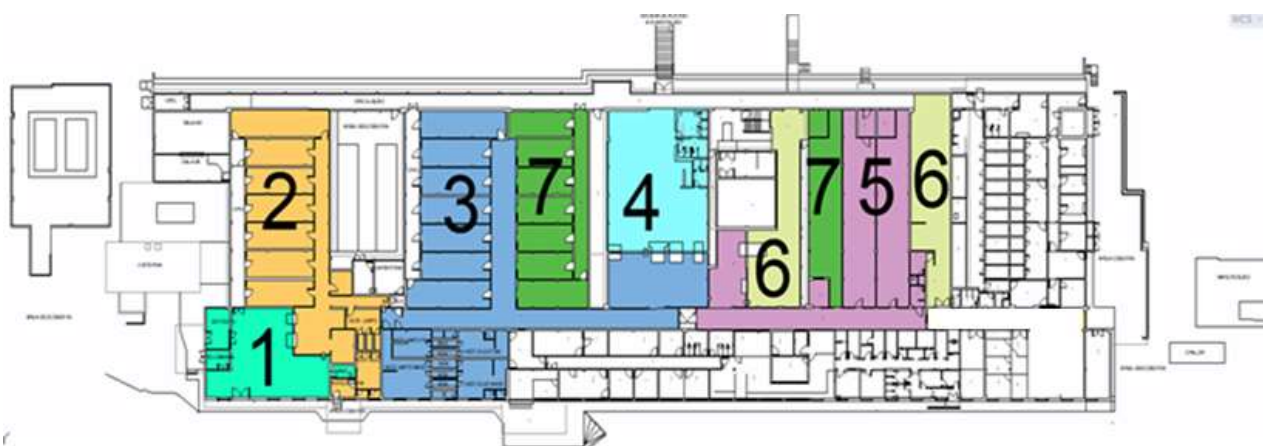
Figura 1: Planta geral do SCRL – (1) Lavagem/Esterilização SPF, (2) Área de Criação de Animais SPF, (3) Área de Criação de Animais Convencional, (4) Área de Lavagem /Esterilização Convencional, (5) Área de criação de Lagomorfos, (6) Área de Lavagem Lagomorfos e Cobaias e (7) Área de Criação de Cobaias e Hamsters.
