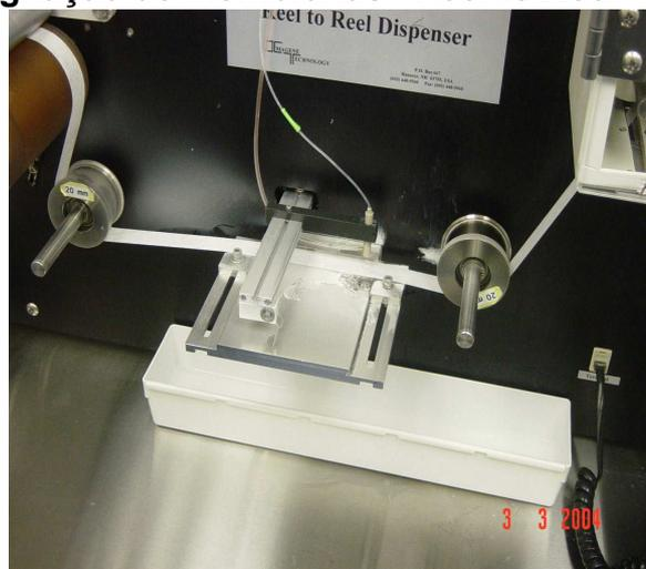
**Fotos 3 e 4: Equipamentos para laminação e corte de membranas**
