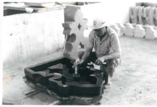
A forma de cimento da peça nº 33 sendo pincelada com óleo de motor de carro. Preparação da forma para a fundição.
