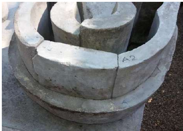
Figura 24: Tasselos montados no berço, formando uma fôrma completa da peça número 29. DPH/COC, 2017.
