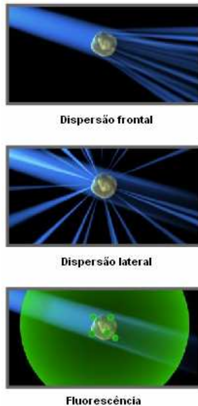
Figura 1.13 – As dispersões frontal e lateral e a fluorescência. Adaptado de Invitrogen 2011.
