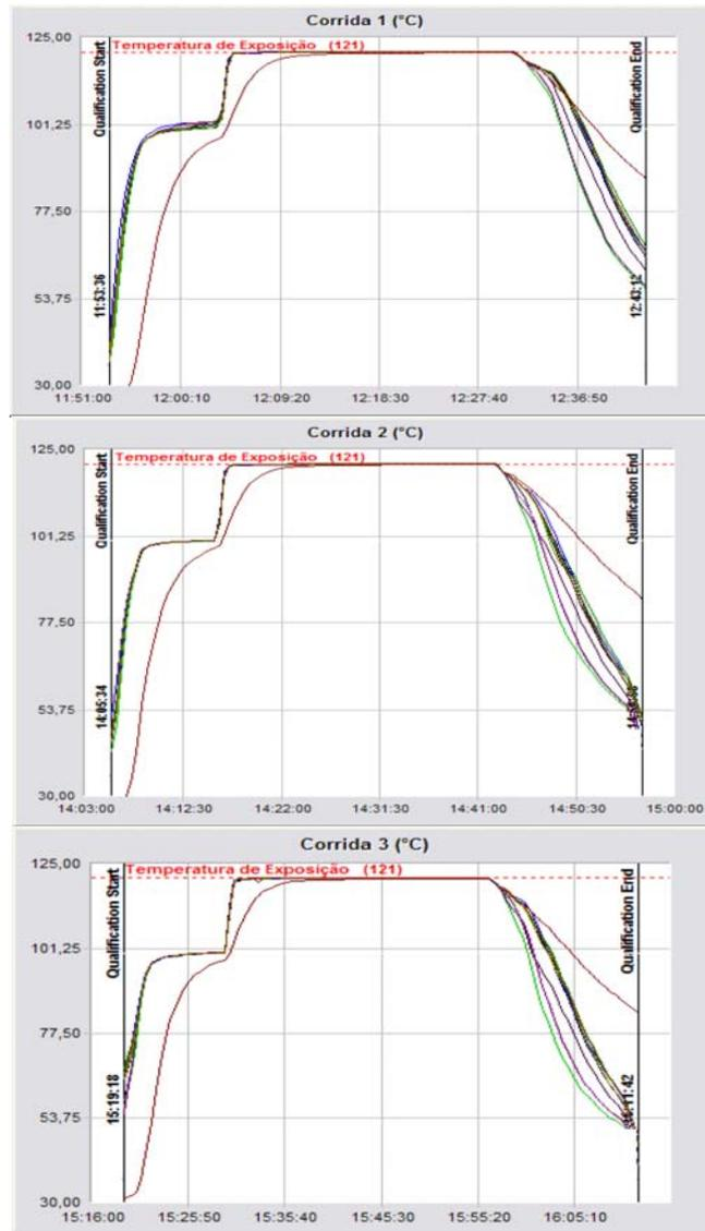
Figura 45 - Gráfico de temperatura das três corridas com a câmara vazia no ciclo líquido.
