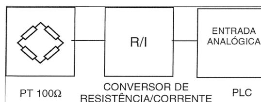
Figura 31 - Diagrama de blocos típico de medição de temperatura
