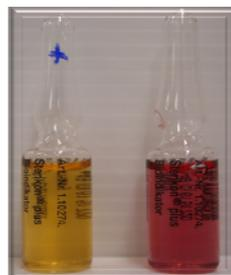
Figura 37 - Alteração da cor do indicador biológico de um resultado positivo.
