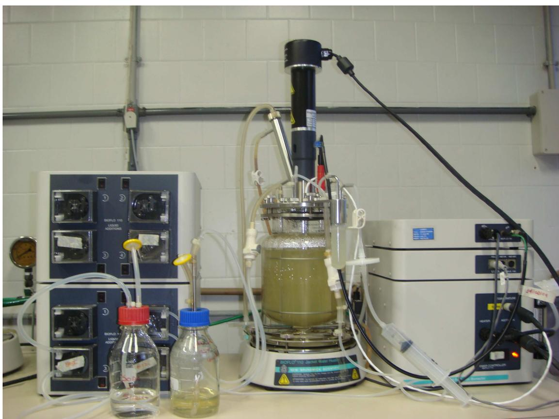
Figura 4.2 Biorreator modelo Bioflo 110 capacidade 2,5L- New Brunswick, USA.
