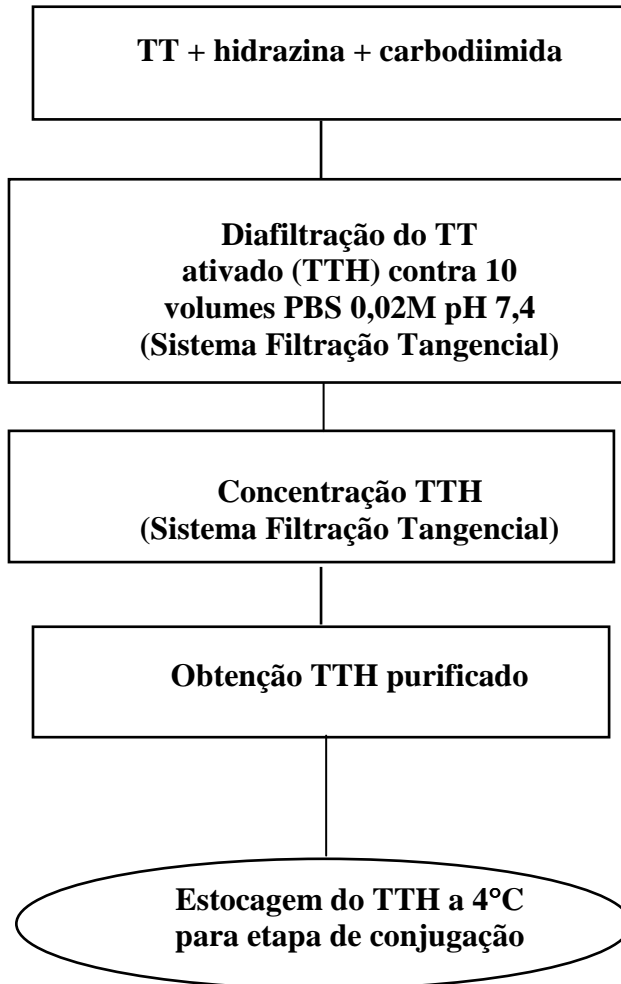
Figura 5. Fluxograma esquemático da ativação do toxóide tetânico para produção da vacina conjugada contra N.meningitidis grupo C.
