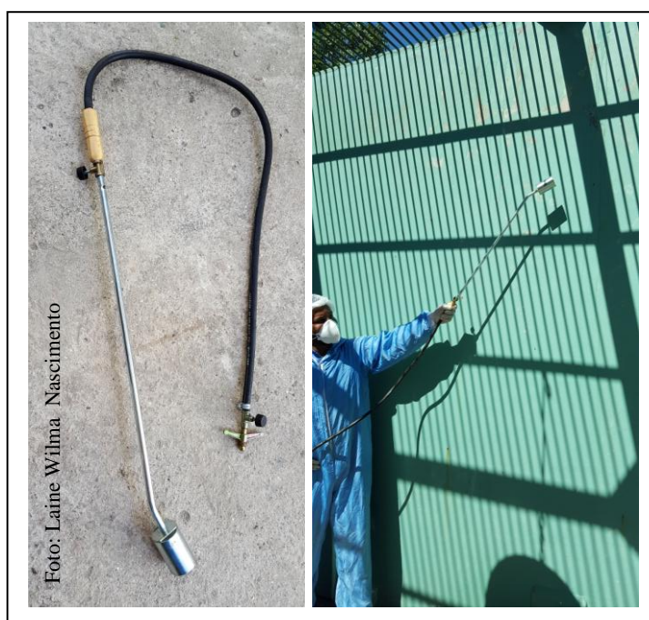
Figura 6.18: Desinfecção física do recinto com vassoura de fogo.
