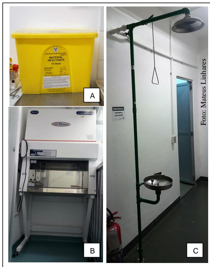
Figura 6.15: Equipamentos de proteção coletiva. A: Caixa coletora de perfurocortantes; B: Cabine de fluxo laminar com lâmpada UV; C: Lava olhos.
