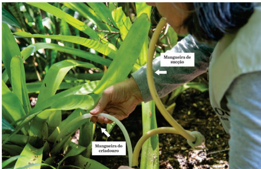
**Figura 15:** Foto da operadora utilizando o ‘sugador de água de bromélia’, as setas indicam a mangueira no interior da bromélia (axila da bromélia) e a mangueira que vai em direção à boca. Fonte: Ricardo Schmidt (IOC/Fiocruz).
