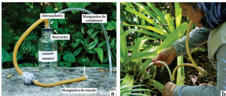
**Figura 9:** Foto do ‘sugador de água de bromélia’; as setas em (a) indicam a mangueira de látex usada como mangueira de sucção, mangueira de criadouro e os materiais utilizados como abraçadeira e borracha; em (b) a operadora utilizando o sugador de água de bromélia. Fonte: Ricardo Schmidt (IOC/Fiocruz).
