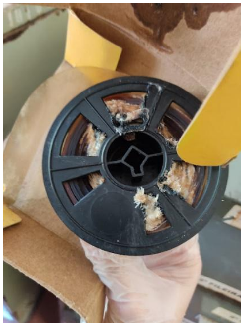
Figura 91 - Rolo de microfilme degradado pela síndrome do vinagre.
