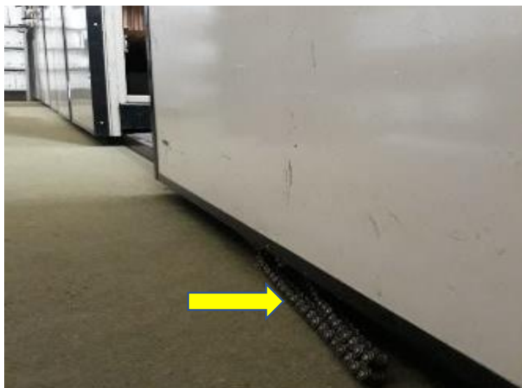
Figura 55 - Corrente de rolamento do módulo da estante deslizante fora do trilho dificultando a movimentação do módulo.
