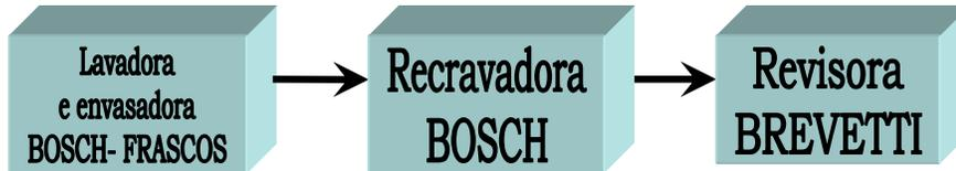
**SEVLI** – Setor de Envase de Vacina Liofilizáveis que utiliza a linha envasadora B+S com capacidade nominal de 18.000 frs/h a qual abastece três liofilizadores Edwards com capacidade para 73.200 frs e uma recravadora B+S com capacidade nominal de 18.000 frs/h.
