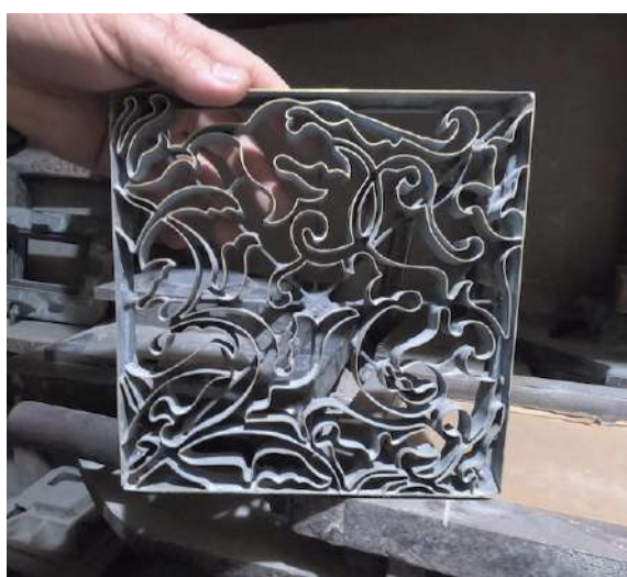
Figura 70 - Matriz de ferro fundido
