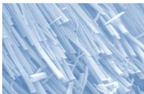
Figura 49 - Tumasita. (amostra retirada de concreto).
