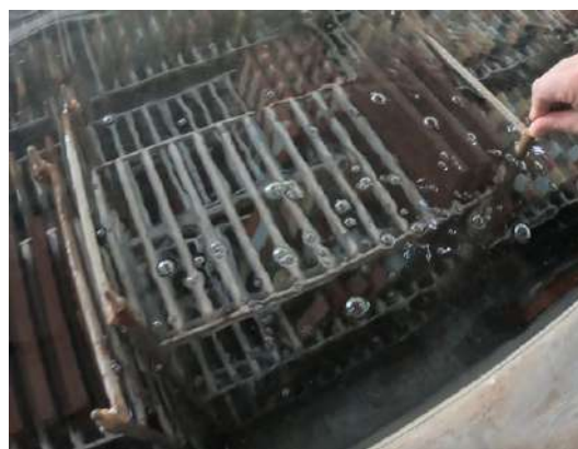
Figura 84 - Bolhas de ar saindo dos ladrilhos
