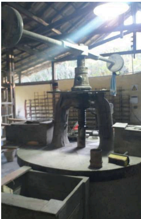
Figura 79 – Prensa hidráulica da Fábrica Ladrilhos Barbacena.
