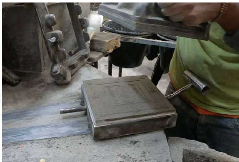
Figura 78 - Finalização da peça de ladrilho hidráulico.
