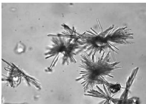
Figura 50 - Gipsita (amostra tratada com solução aquosa diluída em sulfato de alumínio)
