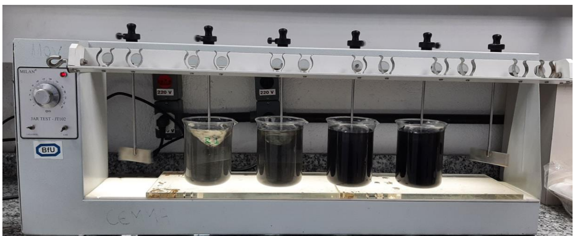
Figura 5. Pós-tratamento do efluente do processo LGA sendo realizado em Jar-Test com CAP em diferentes concentrações.
