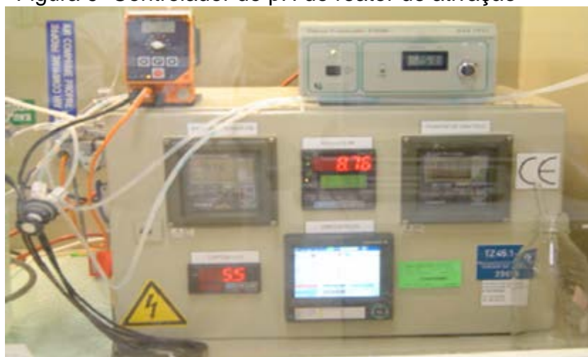
Figura 9–Controlador de pH do reator de ativação
