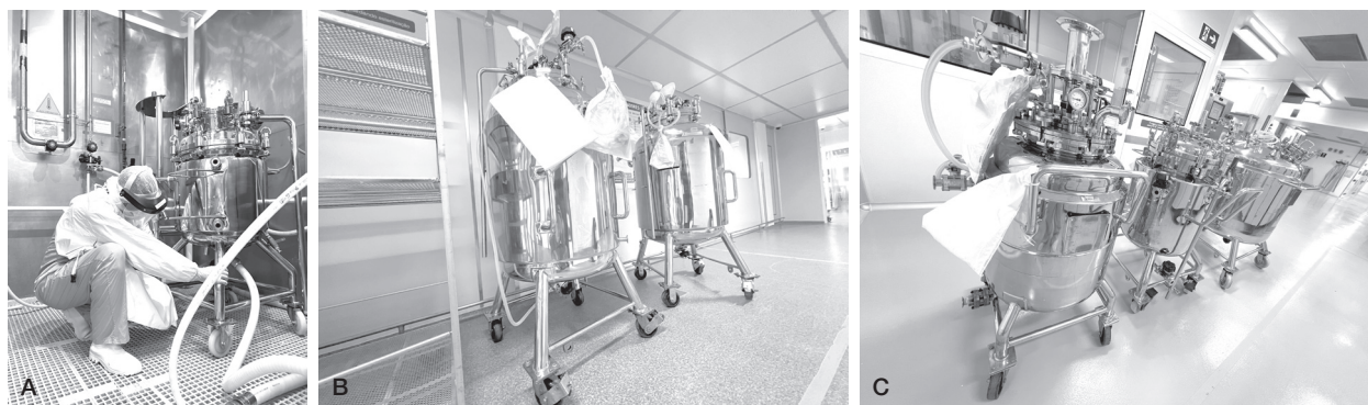
FIGURA 11.16 A: Tanque de aço inoxidável 316 L de 150 L utilizado no preparo de soluções. B: Tanque de aço inoxidável 316 L de 300 L utilizados na formulação da vacina Covid-19. C: Tanque de aço inoxidável 316 L de 150 L utilizados na formulação da vacina contra sarampo, caxumba e rubéola.
