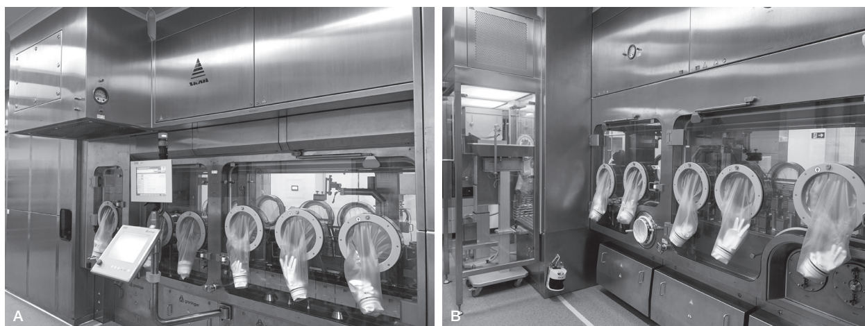
FIGURA 11.19 A: Vista frontal da envasadora sob isolador. B: Vista posterior da envasadora sob isolador.
