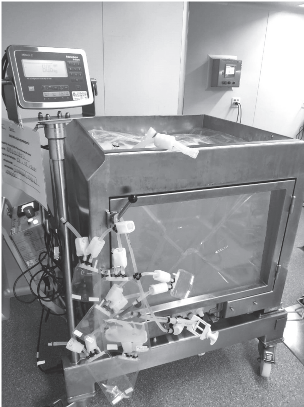
FIGURA 11.15 Sistema single-use de formulação de vacinas, composto com balança para controle de massa adicionada nas bolsas e sistema de agitação. Fonte: Nathalia Rodrigues – Bio-Manguinhos/Fiocruz.
