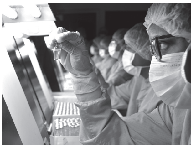
FIGURA 11.23 Inspeção visual manual.
