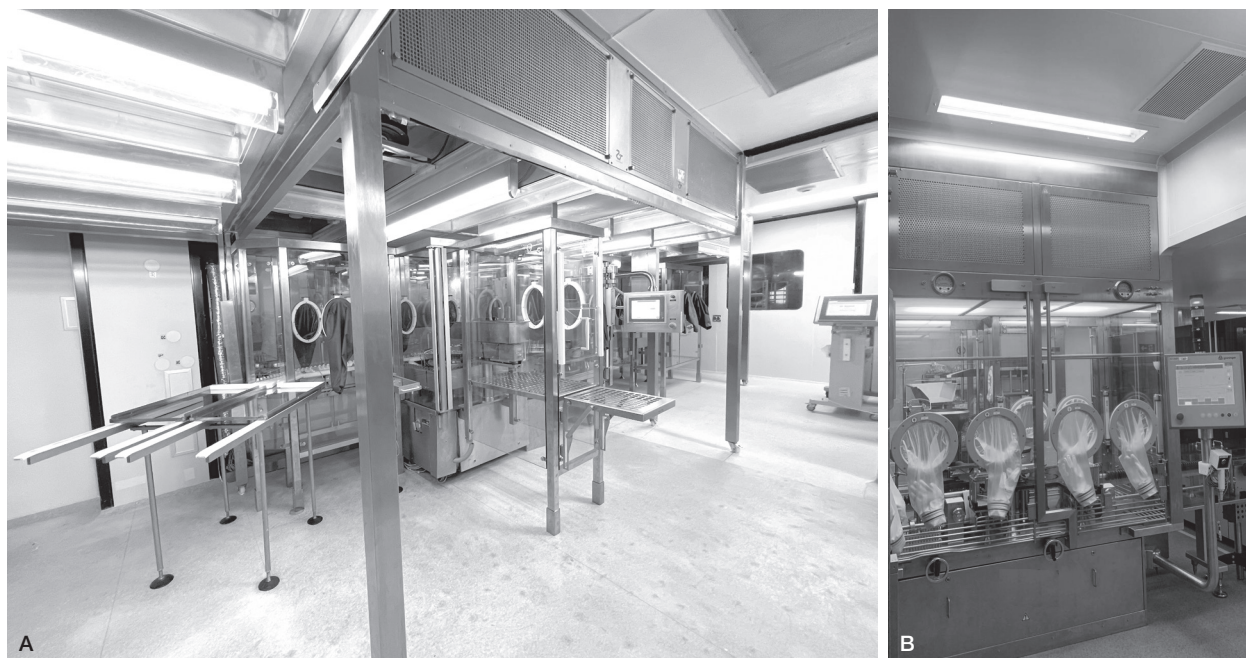
FIGURA 11.18 Exemplos de RABS passivos e ativos. (A) RABS passivos. (B) RABS ativos.
