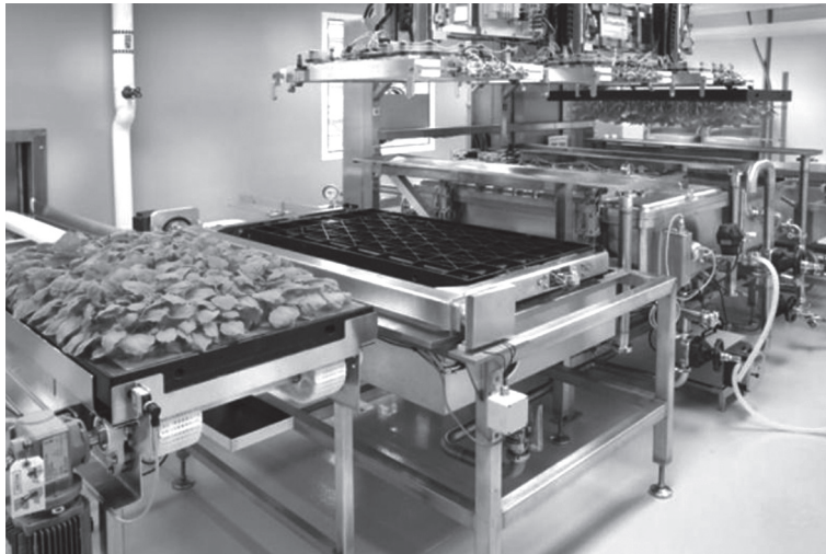
FIGURA 2.5 Equipamento de agroinfiltração utilizado nos laboratórios da Fraunhofer USA. Plantas cultivadas são invertidas e mergulhadas em solução de infiltração dentro de câmara de pressão.
