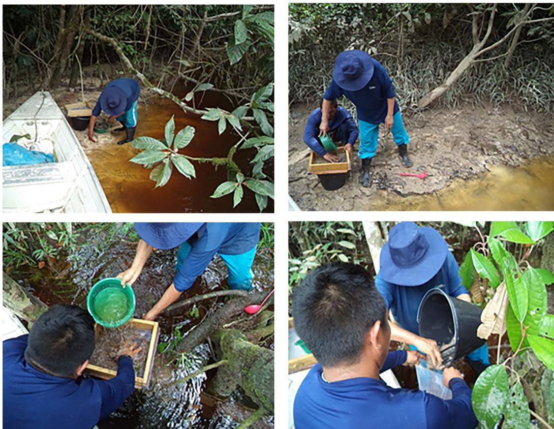
**Figura 6** - Aspectos da coleta, peneiramento e acondicionamento de amostras de sedimentos de fundo no rio Cauaburi (ponto JM-53) e nos igarapés Marié-Mirim e Manguari (pontos JM-42 e 51).
