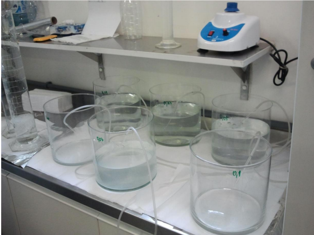
Figura 15 - Montagem do teste toxicológico com peixes Danio rerio : Sequência de cristalizadores para cada concentração, indicando o procedimento de aeração (foto do autor).
