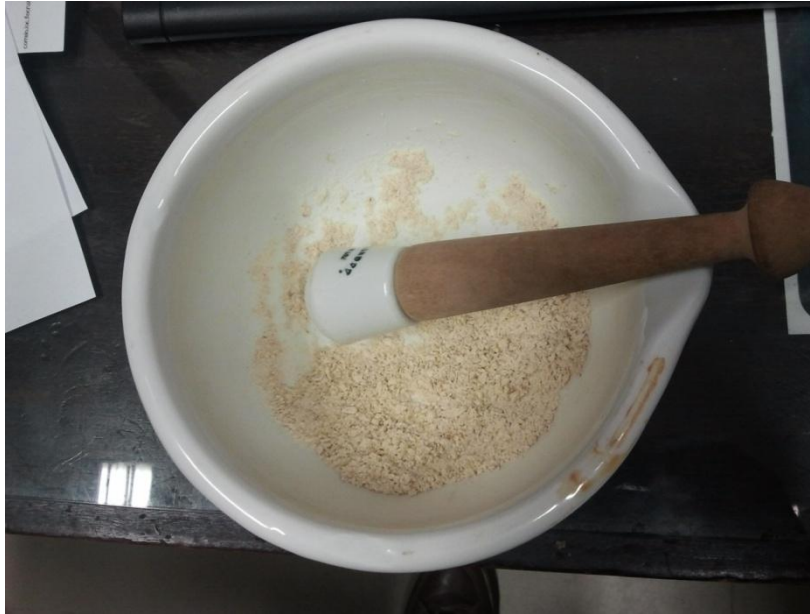
Figura 9 – Cápsula de porcelana e pistilo utilizados no preparo do extrato seco das sementes de Moringa oleifera Lam. (foto do autor).
