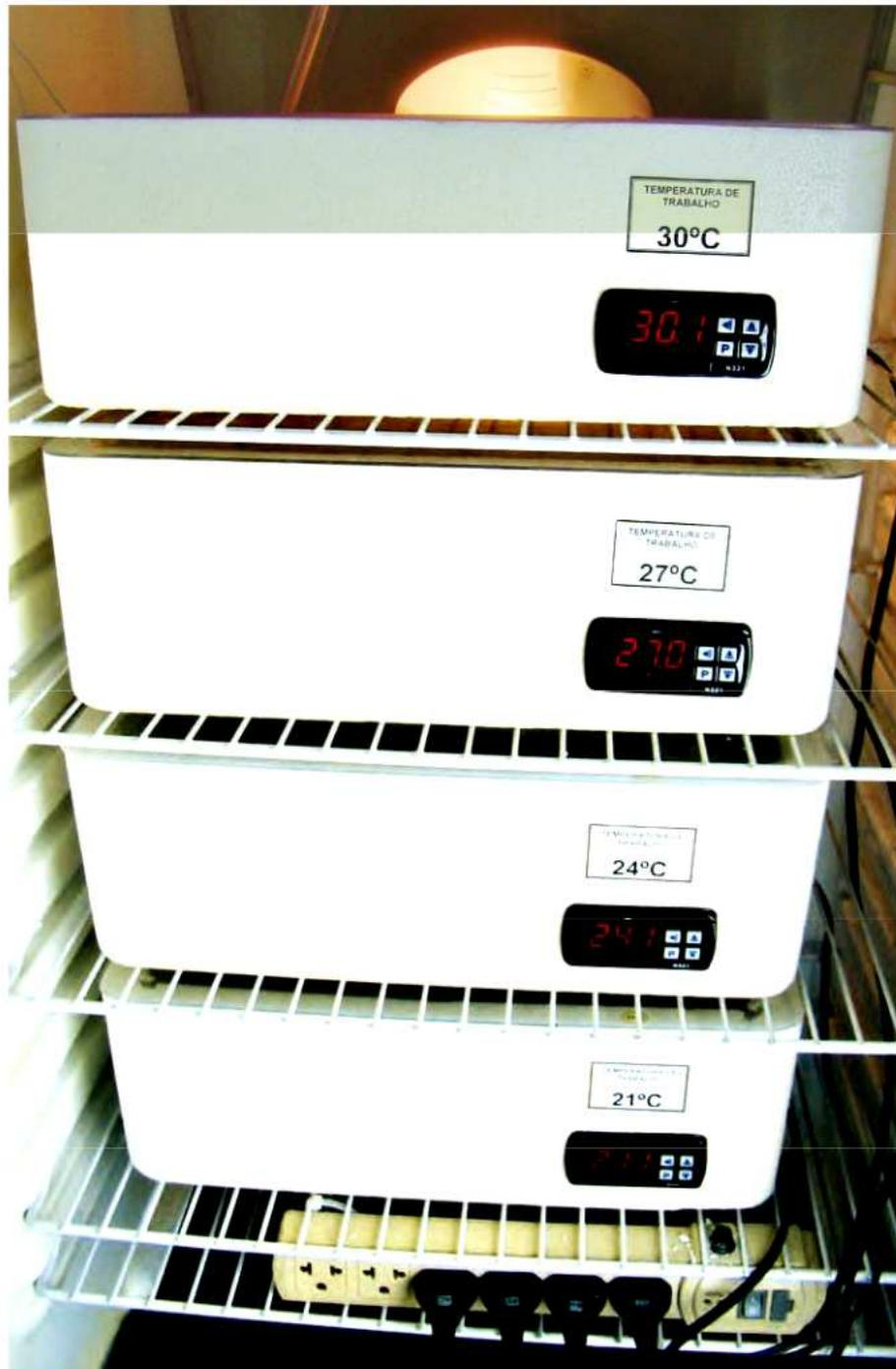
**Figura 4** – Caixas de temperatura controladas, mantidas em estufa BOD, onde foram realizados os ensaios.
