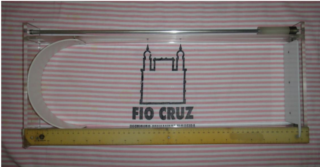
Figura 3: Régua Antropométrica utilizada para obtenção do comprimento dos neonatos.
