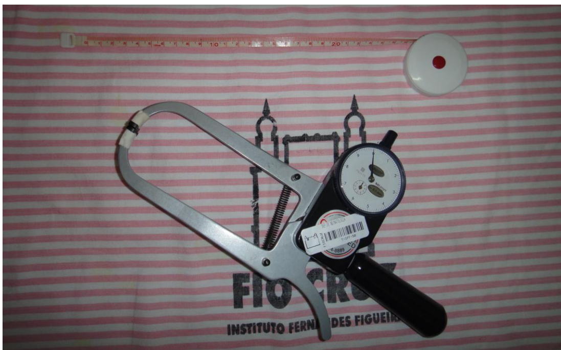
Figura 4: Fita métrica utilizada para obtenção das medidas perímetro cefálico, tamanho do pé, circunferência do meio do braço e perímetro abdominal. Na mesma figura abaixo, o paquímetro utilizado para medir a prega cutânea.
