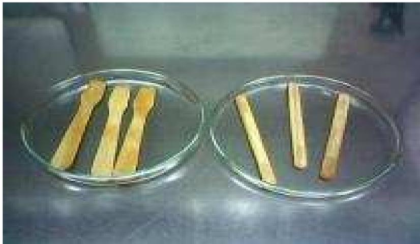
**Figura 8:** Fotografia do ensaio de migração usando palitos de picolé (50cm<sup>2</sup>) e solvente simulante (Etanol/H<sub>2</sub>O 50:50), tempo de contato 10 dias e temperatura de 5°C
