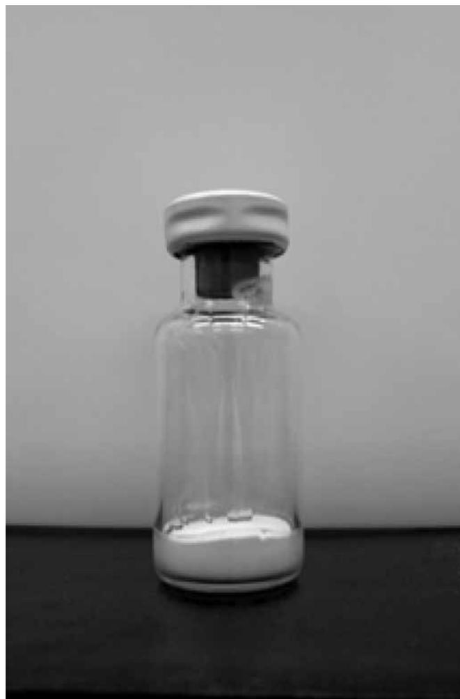
**Figura 1.** Frascos contendo o material de referência após o processo de liofilização. (A) Lote STA01, (B) Lote LIST01
