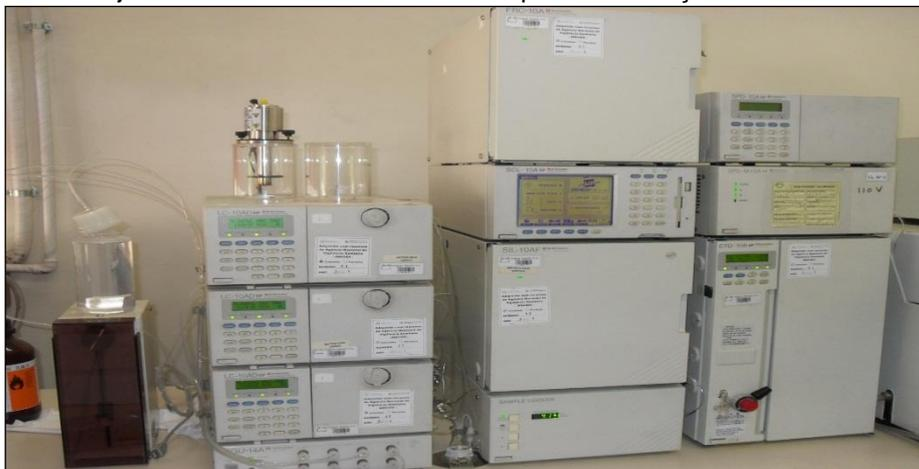
– Cromatógrafo líquido de alta eficiência, fabricante Gilson com detector UV-VIS 152, forno Shimadzu modelo CTO-6A, bomba binária 321 e injetor automático 235p. Programa usado para aquisição de dados Unipoint®. A maior parte dos experimentos foi realizada nesse sistema (figura 13).
