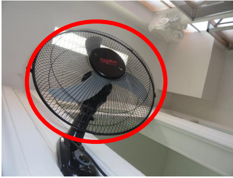
Figura 5 -Ventilador na área de produção , fluxo de ar incide diretamente sobre os alimentos
