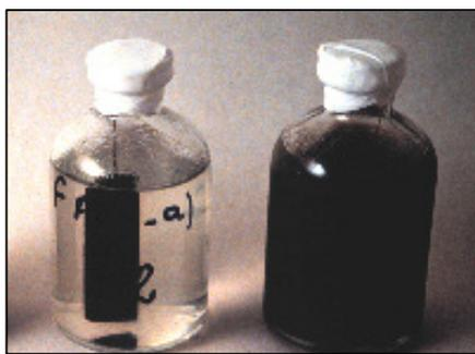
A figura mostra um corpo-de prova de aço-carbono contendo biofilme de BRS aderido à sua superfície e inoculado em meio de cultura Postgate E fresco (frasco à esquerda). Com o crescimento de BRS, observa-se o enegrecimento do meio de cultura devido a formação de sulfeto de ferro (frasco à direita). O acompanhamento diário da cor do meio de cultura (até o máximo de 28 dias) é usado como indicador de detecccção da atividade de BRS.
