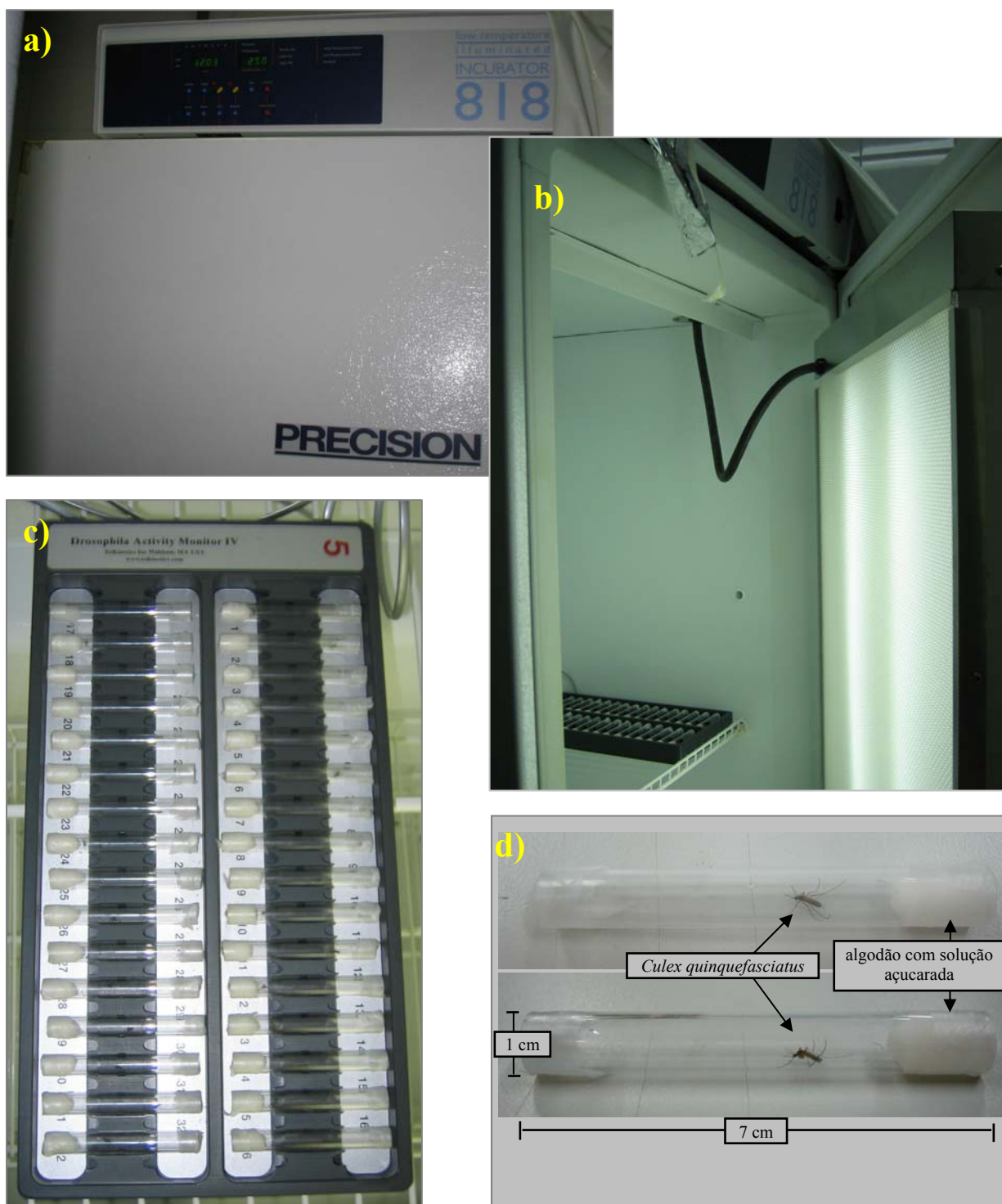
Figura 2.1: Ilustração do experimento de monitoramento da atividade/repouso. a) Incubadora Precision Scientific Mod. 818 com a porta fechada. b) A mesma incubadora com a porta aberta, onde se vê o posicionamento das lâmpadas na parte interna da porta e ainda a placa com os tubos individuais sobre uma das prateleiras. c) Detalhe da placa de 32 tubos individuais contendo um mosquito cada. Na porção central dos tubos um leitor infravermelho detecta o movimento dos insetos. d) Detalhe do tubo de vidro onde os mosquitos são acondicionados individualmente.
