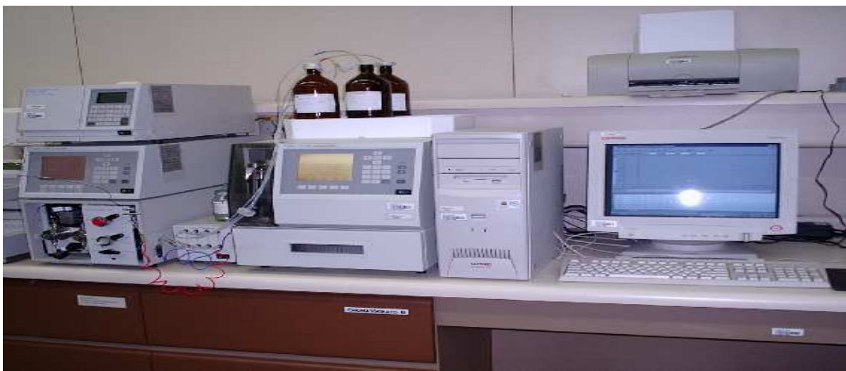
Figura 6 - Cromatógrafo líquido, fabricante Waters com detector ultravioleta-visível óptico completo usado na determinação do requisito reprodutibilidade interna
